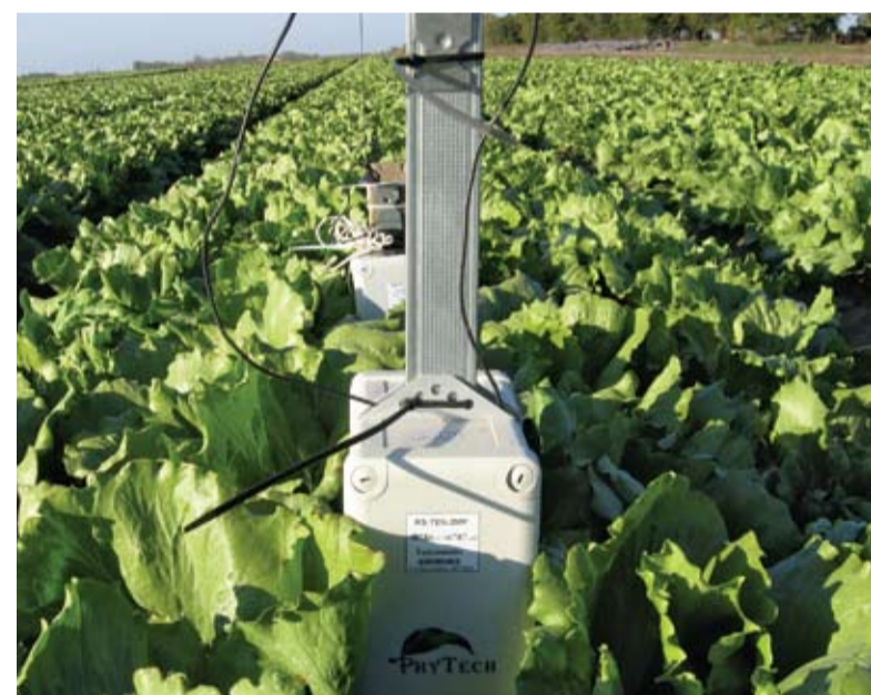
Агростанция «PhyTech» с датчиками влажности почвы и температуры листа на салатном поле
