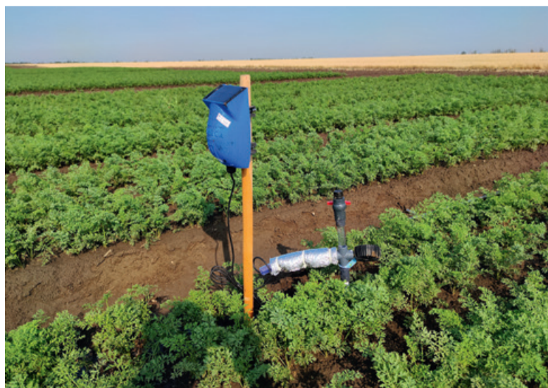
Сеть датчиков влажности почвы ежеминутно отправляет в «Greenvizor» данные, обеспечивая не только контроль качества полива, но и уточнение расчета поливной нормы для следующего цикла орошения
