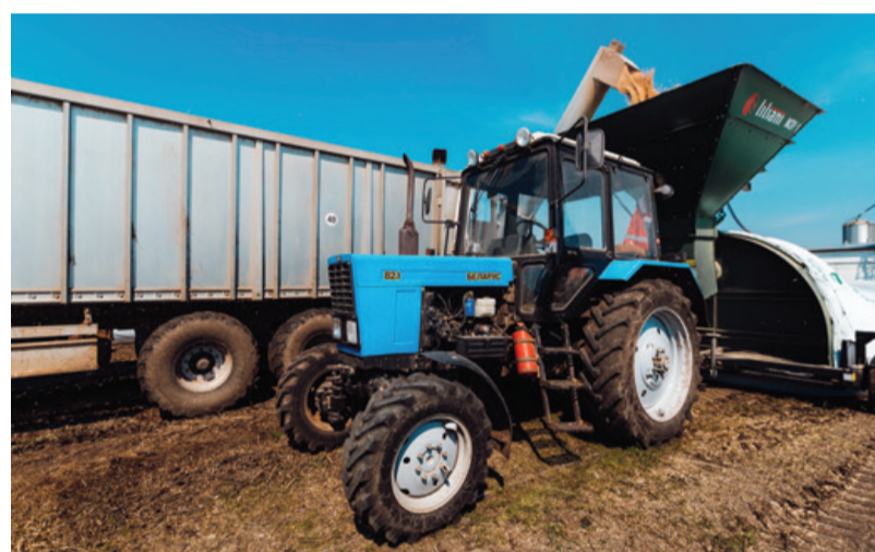
Загрузка зерна в рукава загрузчиком фирмы «Лилиани» МЗУ-1
